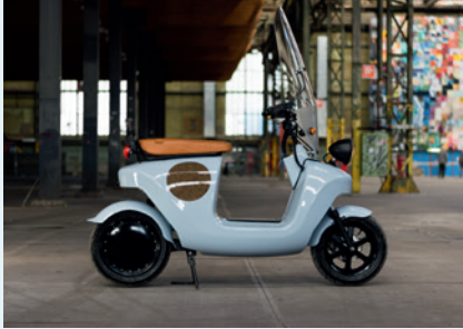
Der Scooter: Elektro-Fahrzeug mit einem Corpus aus Biokompositen
